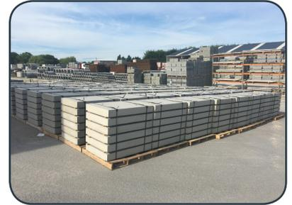
Dalle de recouvrement de caniveau technique
